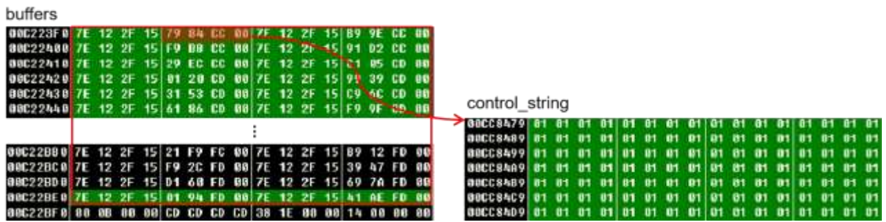
[그림 33] buffers 문자열의 각 Element가 control_string 주소로 지정
